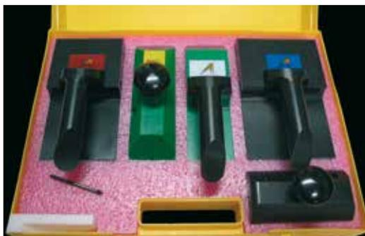
Valigetta contenente set da cinque attrezzi per il taglio di pannelli **CLIMAVER®**. Essi permettono la lavorazione dei pannelli e i tagli dei tratti rettilinei, per la fabbricazione dei raccordi in base al **Metodo del Tramo Recto**.
